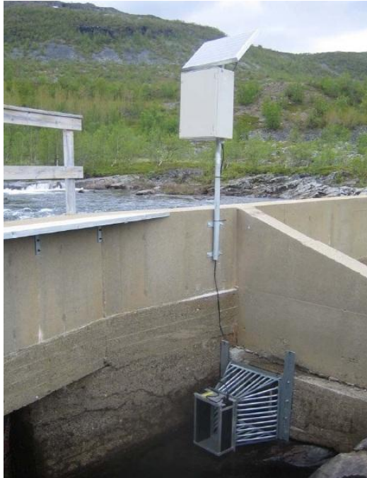
Abb. 8-4: VAKI "Riverwatch Fish Counter" mit Scan- und Kontrolleinheit (aus „www.vaki.is“)
